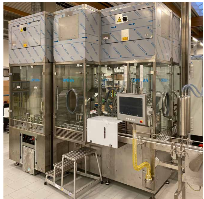
LF-Haube vor dem Probetrieb (Shanghai)
